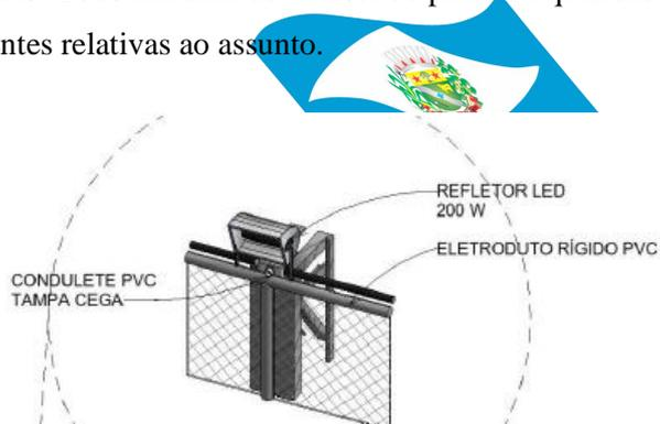
Figura 11 – Detalhe Ilustrativo de Instalação Refletor (Fonte: Autora/2021)
