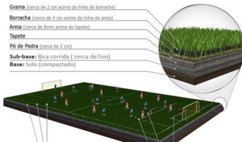
Figura 09– Detalhe Ilustrativo de Instalação e Revestimento (Grama Sintética) (Fonte: Adaptado brasgrama/2021)
